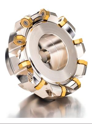
Ein neuer äußerst wirtschaftlicher und produktiver Planfräser, der zwei Arten doppelseitiger negativer WSP verwendet. Wirtschaftliche achteckige ON..06-WSP mit 16 Schneidkanten und ap von 4 mm sowie produktive quadratische SN.. 17-WSP mit 8 Schneidkanten und ap von 7 mm. Aufsteckausführung ( $\emptyset$  = 50 – 250 mm), erhältlich mit unterschiedlicher Zahnteilung. Körper behandelt für längere Standzeit des Werkzeugs.
