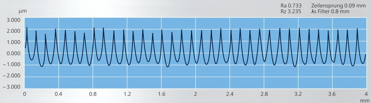
Exemplarische Darstellung einer Rauheitskurve bei einem mit **Microcut**-Fräsern hergestellten Bauteil
