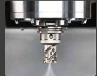
Kühlluft durch Spindel
