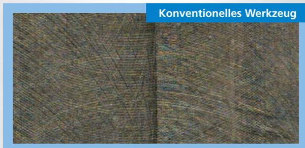
Material: Inox 1.4301, Ra: 0.35  $\mu\text{m}$ , Rz: 1.73  $\mu\text{m}$
