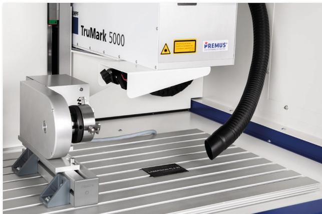
**Drehachse DA65 für Umfangsbeschriftung:**
